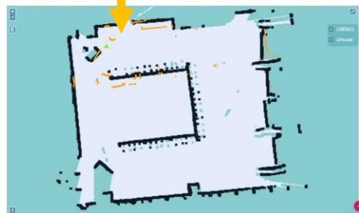
位置把握3Dレーザー&カメラ 画像解析により自動Map生成 ※レーザー-SLAM、VisualSLAM
